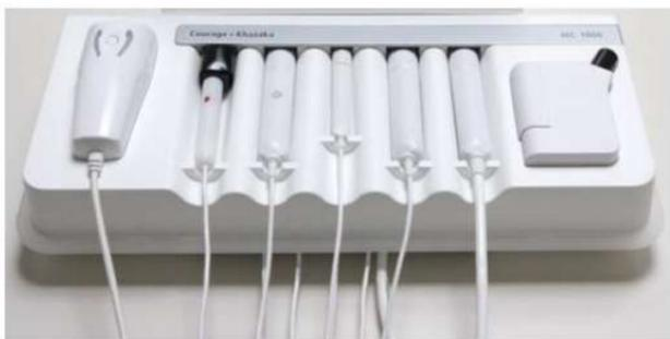
Hautanalysegerät (Courage & Khazaka electronic GmbH). Die Messung erfolgt nicht-invasiv durch Auflegen der Sonden & Kameras auf die Haut.
