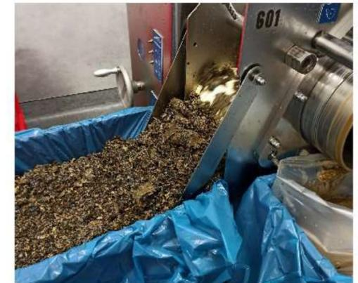
Versuch zur maschinellen Trennung von Muschelfleisch und Schale
