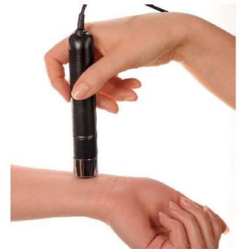
Die Messung basiert auf Absorption/Reflexion. Die Sonde sendet drei spezifische Wellenlängen von Licht aus. Ein Sensor misst, wie viel davon von der Haut reflektiert wird.
