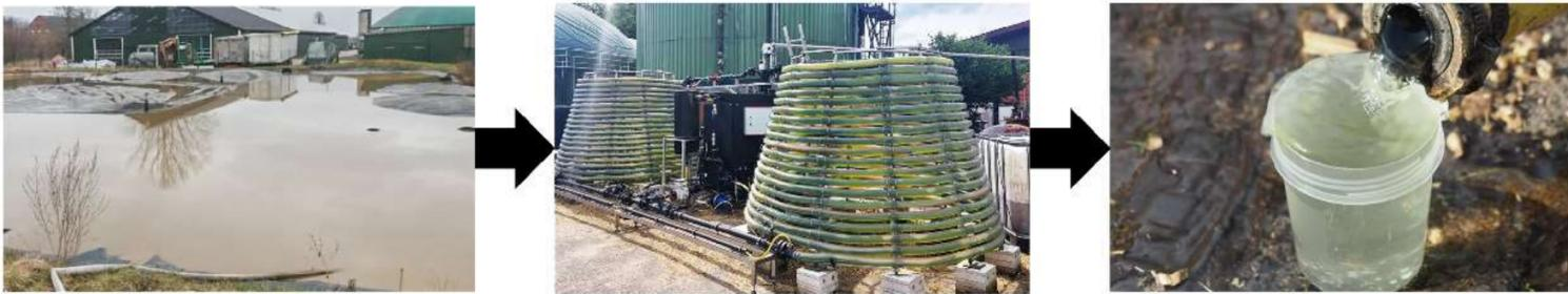
Abb. 1: Kultivierung des auf Oberflächenwasser adaptierten Algenmix im Algenreaktor (GICON) auf der Biogasanlage B.E.S.
